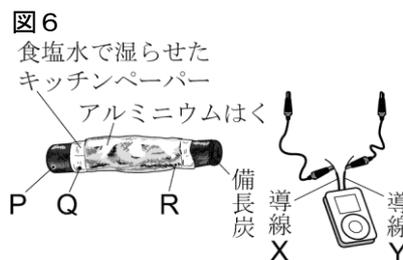
(2) 実験4で、電子オルゴールの導線Xと導線Yは、図6のP～Rのどの部分にそれぞれ接続されているか。表1のア～エから、適当なものを一つ選び、ア～エの記号で書け。
