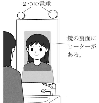
㉞ この洗面化粧台に使われている電流回路を、スイッチ、電熱線、2つの電球の電気用図記号を用いて解答欄の図を完成させなさい。
