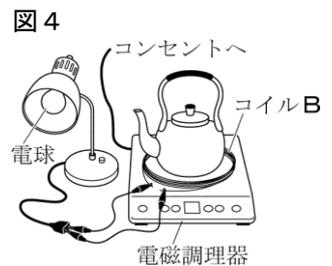
**【実験Ⅲの説明】** 電磁調理器の中にあるコイルに交流が流れると、コイルのまわりの磁界が絶えず変化する。そのため、コイルBの内部の磁界が変化して電磁誘導が起こり、誘導電流が流れて電球が点灯した。
