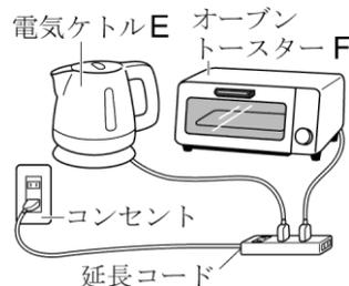
Tさん：接続してはだめだよ。延長コードの表示に「合計 1500Wまで」と書いてあるよ(**図 22**)。電気ケトル**E**は1200Wで、オーブントースター**F**は900Wだよ。延長コードを使っても並列に接続されるから、つないだ電気器具の電力の合計が表示をこえると、延長コードが過熱して、火災になる危険があるんだ。
