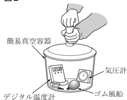
〔実験2〕 何も入っていない簡易真空容器の中に、少量の水と線香のけむりを入れてふたをし、しばらく放置した。容器の中が透明になった後、空気をぬいていくと、容器の中がくもった。
