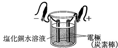
**実験2** 水溶液に電流が流れるとき、水溶液中の電極に起こる変化を調べるために、図2のように塩化銅水溶液をビーカーに入れて電流を流し、そのときの様子を観察した。
